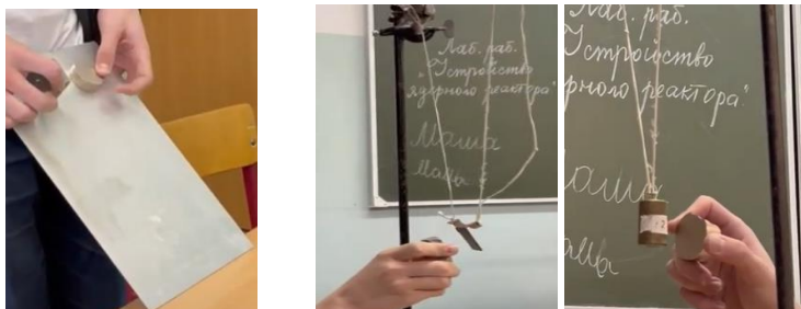
Рис.5. Эксперименты, демонстрирующие тормозящее действие токов Фуко
