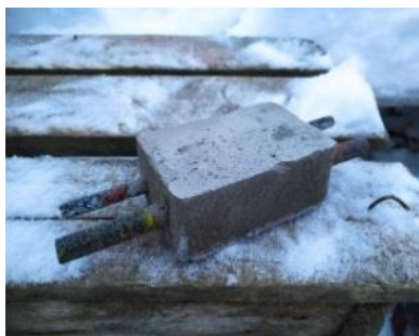
Рис.10. Бетонный образец с базальтопластиковым стержнем внутри
