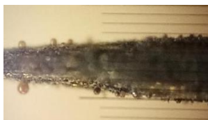
Рис. 2. Игла графитового стержня со сферическими образованиями после резистивного нагрева на воздухе, вид в оптический микроскоп
