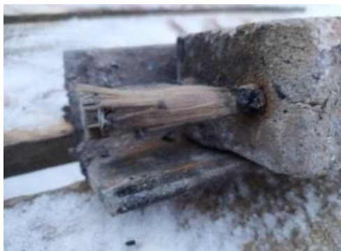
Рис.13. Наглядность волокнистой структуры базальтопластика
