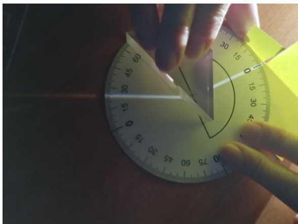
Рис.19. Прохождение луча света через призму с преломляющим углом 45^\circ
