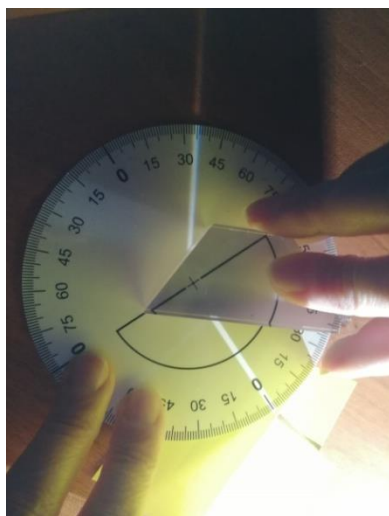
Рис.20. Прохождение луча света через призму с преломляющим углом 60^\circ
