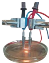
Рис.4. Ход эксперимента резистивного нагрева графитового стержня на поверхности этилового спирта ( C_2H_5OH )
