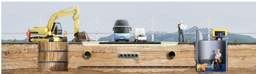
Рис. 1. Бестраншейная прокладка трубопровода
